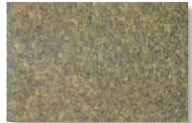
Мелкозернистый сплав (2000 x)
