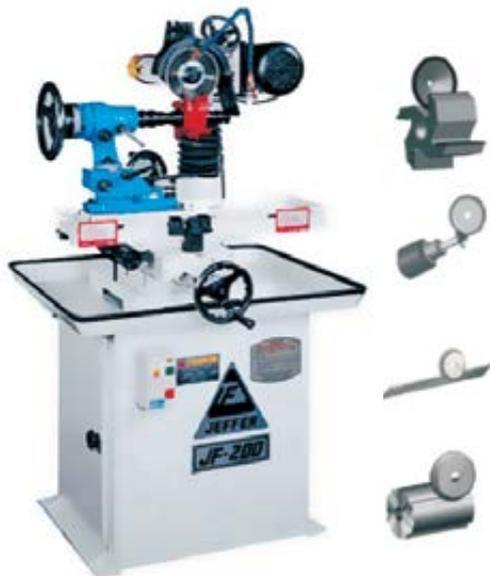
Станок JF-180/200 предназначен для заточки пил, фрез, плоских ножей, концевых фрез (свёрл).
