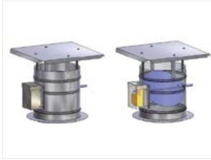
Алюминиевые задвижки (шиберные заслонки) располагаются на крыше сушильной камеры, их количество и диаметр (370мм или 450мм) варьируются в зависимости от размеров самой камеры. Все задвижки оснащены электроприводами (BILEMO Швейцария) степень открытия регулируется автоматически компьютером и отображается на мониторе у оператора. Для предотвращения попадания осадков в камеру, сверху все шиберные заслонки защищены аэродинамическим экраном.
