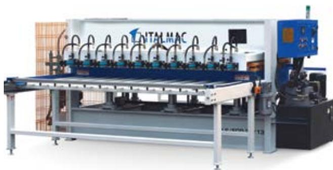
Предназначен для склейки бруса и щита из массива древесины, а также двустороннего облицовывания щита и плитных материалов. В качестве облицовочного материала используется натуральный шпон ценных пород древесины, пленка ПВХ, пластик. Применяются на средних и крупных предприятиях по производству мебели, дверей, окон и прочих столярных изделий.
