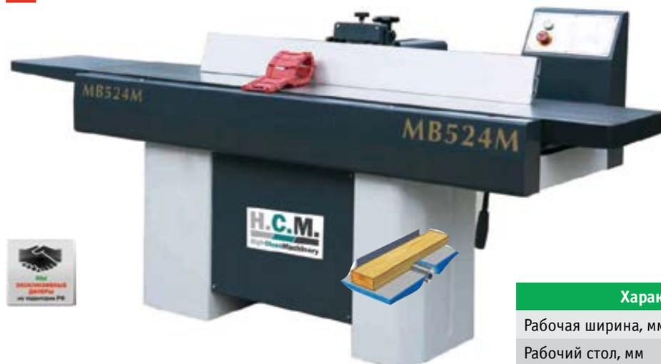
Предназначены для прямолинейного одностороннего строгания изделий из древесины по плоскости и снятия фасок под углом.
