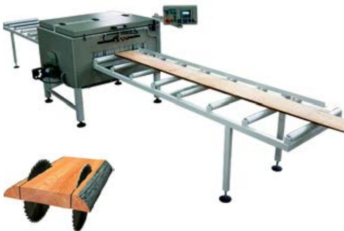
Двухпильный кромкообрезной станок MN-315 предназначен для обрезки и продольного раскроя необрезного пиломатериала. Оптимизация обрезки кромок достигается посредством лазерных указателей. Станок применяется на лесопильных предприятиях, мебельных фабриках и т.д. Скорость подачи регулируется бесступенчато. Ширина распила задается через программатор. Станок поставляется с подающим и принимающим рольгангами, длиной по 3 метра.
