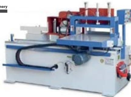
Станок предназначен для фрезерования мини-шипа последовательно на обоих концах пакета заготовок, фрезерованные заготовки поступают далее на пресс торцевого сращивания через отдельно стоящий клеена-носящий станок.
