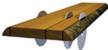
Трехпильный кромкообрезной станок UDKY/D с цифровым позиционированием пил имеет одну неподвижную и две подвижных пилы и предназначен для получения обрезных досок из необрезного пиломатериала. Применяется на лесопильных предприятиях высокой мощности. Дополнительный уплотненный стальной корпус. Жесткий и отшлифованный стальной стол из специального сплава.
