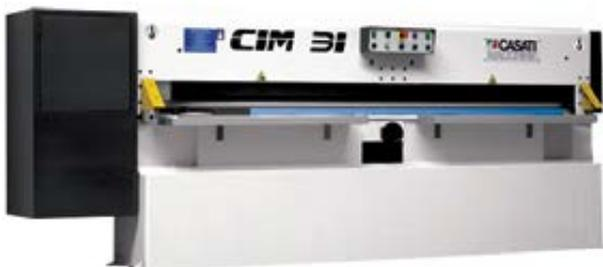
Предназначена для чистовой обрезки шпона в заданный размер и вырезки дефектных мест. Прямолинейная и параллельная рубка шпона - существенное достоинство станков этого типа. Высокая точность рубки обеспечивает в дальнейшем качественное склеивание шпона любых сортов.
