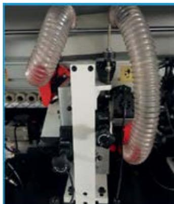
На узле установлены двигатели итальянской фирмы ELTE, мощностью 0,55 кВт
