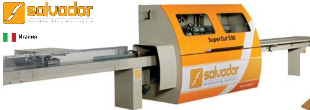
Линии оптимизации предназначены для поперечного раскроя древесины, удаления дефектов (сучков, гнили и т.п.) с возможностью оптимизации по сортам.
