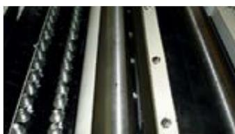
Два ряда секционных стружколомов выполнены из серого чугуна.
