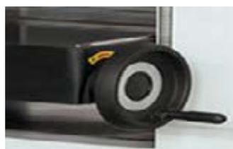
Подъем / опускание стола осуществляется вручную с помощью удобного маховика. Отображение размера по линейке с миллиметровой шкалой.
