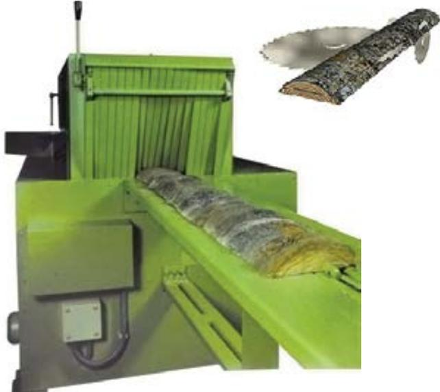
Станок предназначен для получения обрезной доски из горбыля за один проход.
