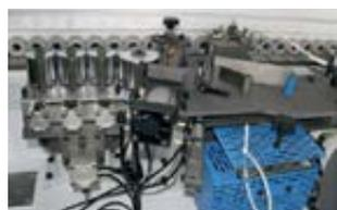
Узел нанесения клея и приклеивания кромки
