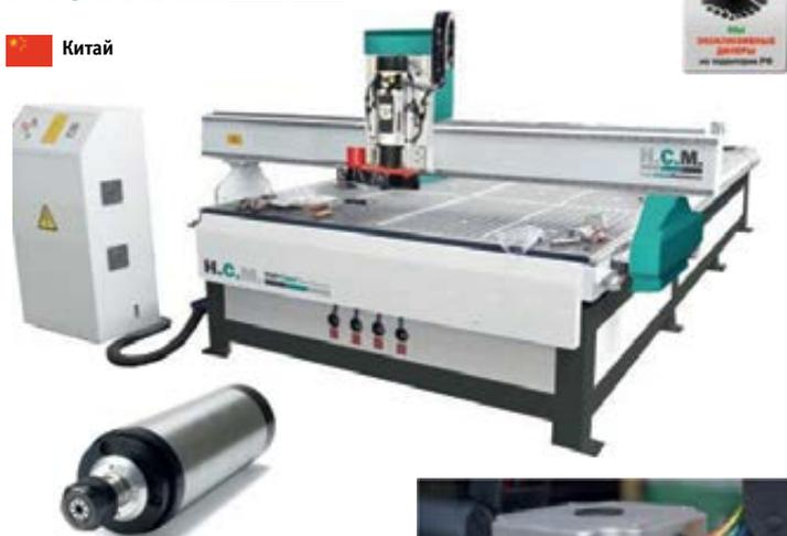
Станок оснащен высокочастотным фрезерным шпинделем с воздушным охлаждением, мощностью 6 кВт, и возможной частотой вращения до 18 000 об/мин.
