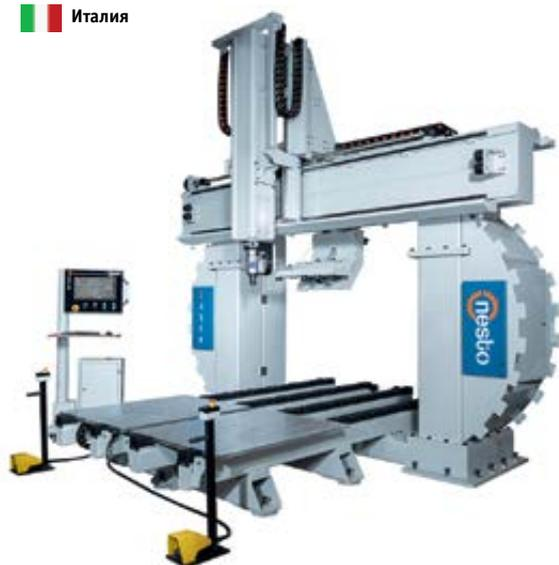
5-ти осевой токарный центр с ЧПУ предназначен для серийного и поштучного производства точенных и фрезерованных изделий таких как балясины, ножки стульев, подставки и опоры столов, элементы декора и другие изделия сложных точенных и фрезерованных форм.
