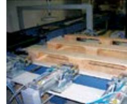
IMP/MAG Гидравлический транспортер выгрузки
