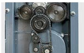
Привод подающих валцов осуществляется посредством цепной и шестеренчатой передачи.
