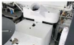
Узел предварительного фрезерования
