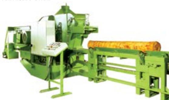
Станки этой серии разработаны специально для распиловки больших объемов круглого несортированного пиловочника диаметром от 120 мм до 360 (390) мм, выпускаются в комплектации с 4 или 6 пильными дисками. В зависимости от мощности установленных двигателей возможно достижение очень высокой производительности. Станок отличается очень стабильной и прочной конструкцией.
