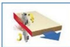
Узел снятия свесов кромочного материала
