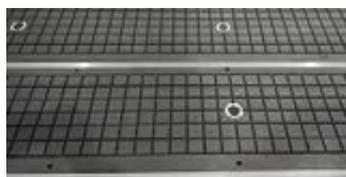
Вакуумный и механический стол с «Т»-пазами крепления 4 зоны
