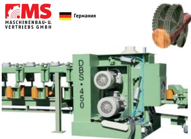
Тяжелый бревнопильный дисковый станок проходного типа серии DBS предназначен для распиловки круглого леса диаметром до 450 мм.
