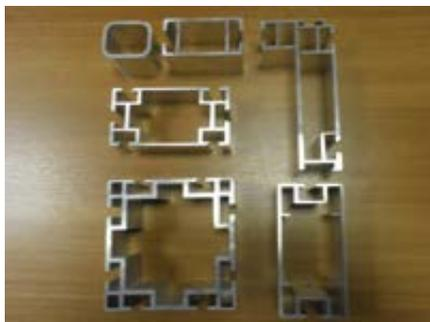
Благодаря использованию замкнутых профилей запатентованного дизайна Incoplan (на фото) камеры выдерживают снеговую нагрузку до 240 кг/м<sup>2</sup>, что соответствует 6 (максимальному) классу, и скорость ветра до 120 км/ч.
