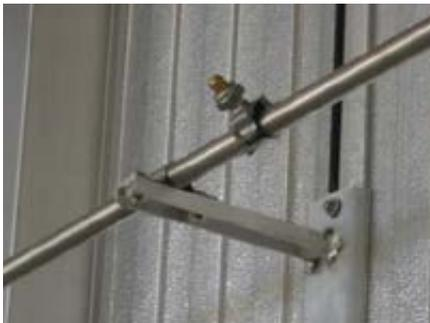
Базовая система орошения в сушильных камерах INCOPLAN, состоит из трубопровода из нержавеющей стали (ASIX) и форсунок (пластиковых или из нержавеющей стали), на входе в который размещается электромагнитный клапан с фильтром. Опционально, для сушильных камер большого объема, для сушки экзотических пород древесины, а так же для обеспечения гарантированно качественных параметров сушильного процесса, возможно оснащение камер специальной воздушно-водной системой орошения (рабочее давление 5-6 бар).
