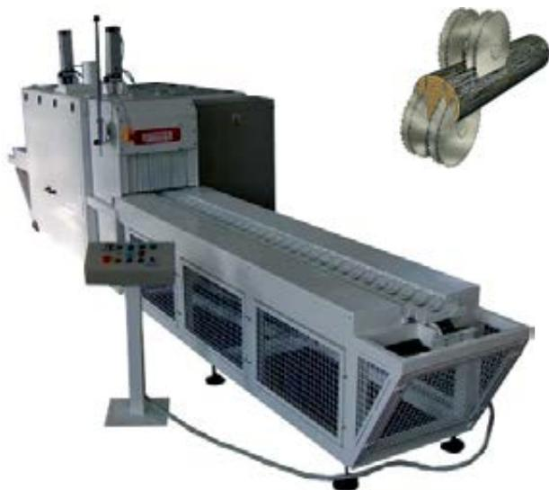
Станок предназначен для распиловки круглого леса на двухкантный брус, необрезную доску и горбыль.
