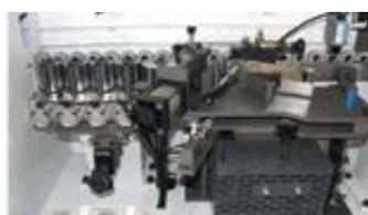
Узел нанесения клея и приклеивания кромки
