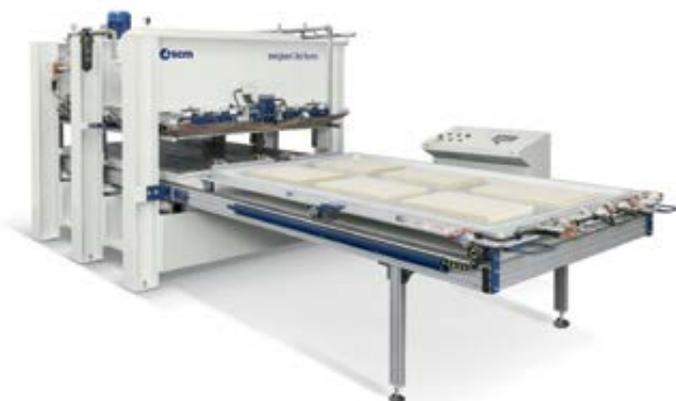
**Электронное управление** каждой фазой цикла прессования с программами, персонализированными благодаря специализированному программному обеспечению для трёхмерного ламинирования.
