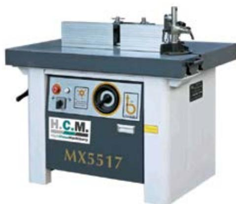
Станки предназначены для выполнения разнообразных фрезерных работ по дереву по направляющим линейкам с ручной подачей (изготовление вагонки, половой доски, плинтуса, наличника, филенки и других столярных и мебельных изделий).
