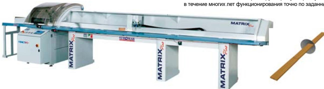
Станок Matrix исключительно надежен, точен и прост в управлении. При дополнительной оснастке системой выбора необходимых длин заготовок позволяет не только осуществлять вырезку дефектов, но и быстрый раскрой заготовок в зависимости от одной из 99 введенных программ. Данная опция исключительно полезна в случае, когда есть необходимость получения большого количества заготовок строго заданной длины.
