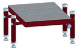
Рабочий стол представляет собой цельнофрезерованную, полированную массивную плиту. Перемещается на 4-х винтовых опорах, что абсолютно исключает перекося стола при обработке заготовок. Подобная система зарекомендовала себя как очень точная и надежная.
