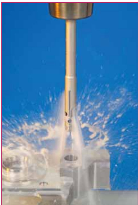
Подвод СОЖ при обработке сквозных отверстий
