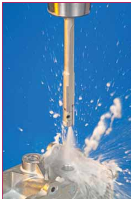
Подвод СОЖ при обработке глухих отверстий
