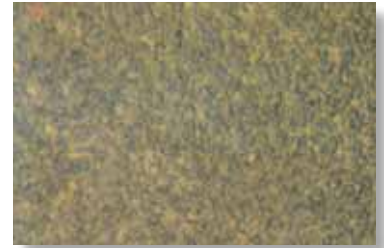
Мелкозернистый сплав (2000 x)
